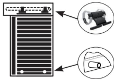
Prima di installare il motore verificare che sul serramento siano presenti i blocchi di sicurezza superiori e gli stopper inferiori.
